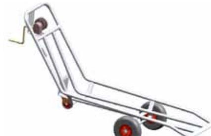
Diseñado para reducir las labores de retirada de cadáveres en granjas porcinas. Provisto de un torno capaz de arrastrar animales de elevado peso hasta situarlos sobre el carro. Esta acción se efectúa con un mínimo esfuerzo gracias a un perfil sin pendientes. El centro de gravedad y el eje están compensados para que el traslado de la baja no suponga apenas esfuerzo.
