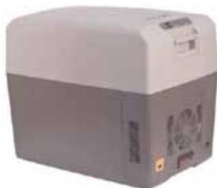
Capacidad óptima para: 125 semenbags/107 tubos/160 boteclips. Calentamiento y refrigeración por célula Peltier por resistencia. Regulador de temperatura digital con resolución: 0.1°C. Zona neutra incorporada. Alarmas de aviso. Conexiones a 220V y en vehículos a 12V. Medidas exteriores: 530 x 360 x 450mm. Peso aprox.: 10Kg
