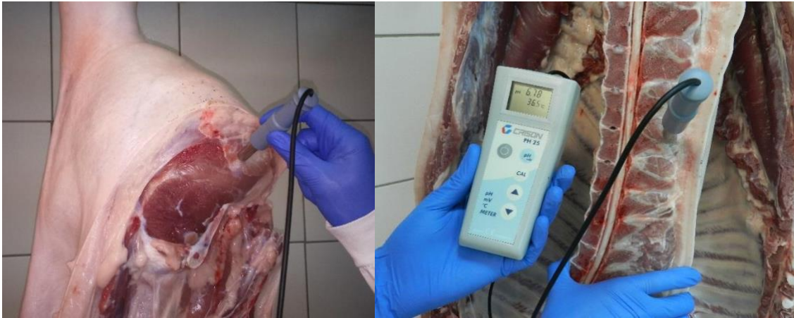
Figura 1. Mesura de pH en el múscul semimenbranosus (esquerra) i en el longissimus (dreta).
