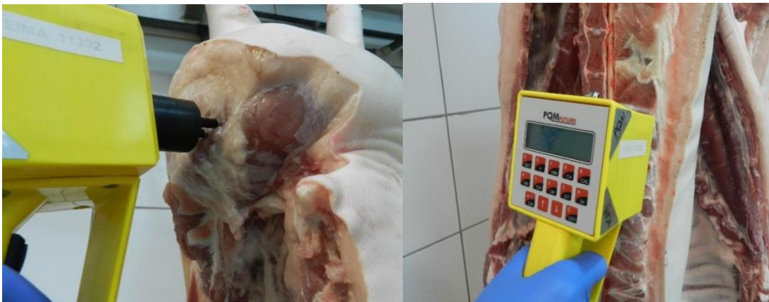
Figura 2. Mesura de conductivitat elèctrica en el múscul semimenbranosus (esquerra) i en el longissimus (dreta).
